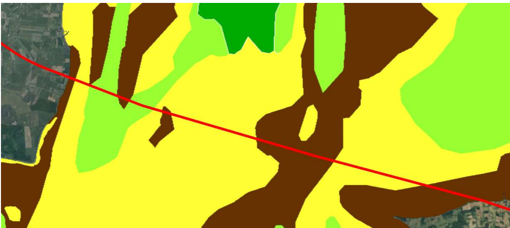
Figur 3.11: Havbundssedimenter, GEUS 2014. Mørkegrøn: Dynd og sandet dynd. Lysegrøn: Dyndet sand. Gul: Sand. Brun: Moræneler
