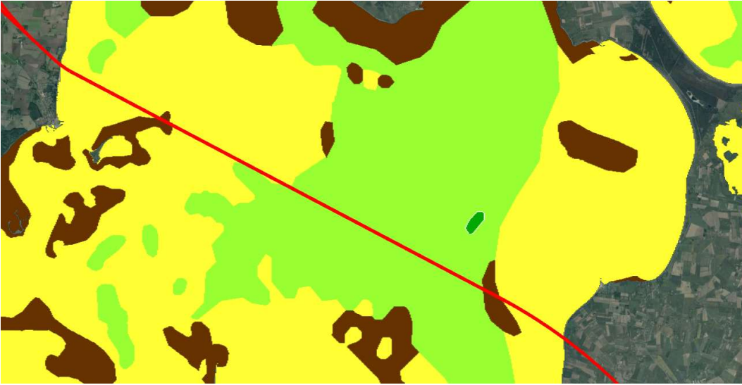
Figur 3.14. Havbundssedimenter, GEUS 2014. Mørkegrøn: Dynd og sandet dynd. Lysegrøn: Dyndet sand. Gul: Sand. Brun: Moræneler
